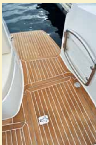
El acceso a bañera, con un ancho de paso de 0,60 metros, se ha situado a babor, protegido por una pequeña portezuela.
