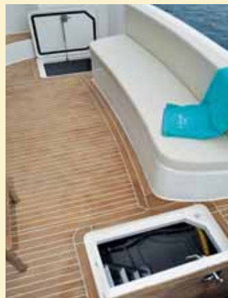
Una tapa en cada banda de la bañera nos descubre sendos accesos a la cámara de motores equipados con escalera tubular de inox.
