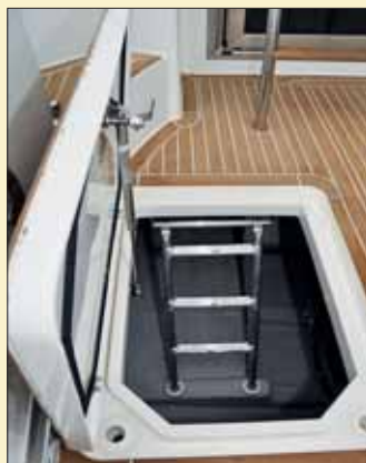
Una tapa en cada banda de la bañera nos descubre sendos accesos a la cámara de motores equipados con escalera tubular de inox.
