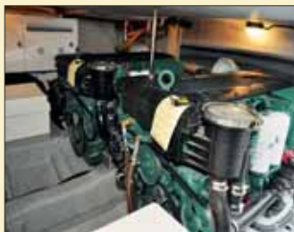
Cámara de motores con los dos Volvo Penta D4-300 IPS400 de 300 CV cada unidad.
