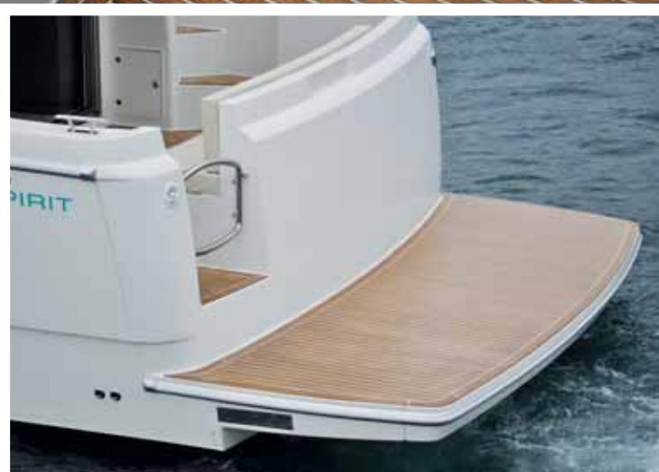
La plataforma de baño incluye, en unas dimensiones de 3,70 x 1,25 metros, la escalera de baño y la ducha de agua fría y caliente escamoteadas a babor.
