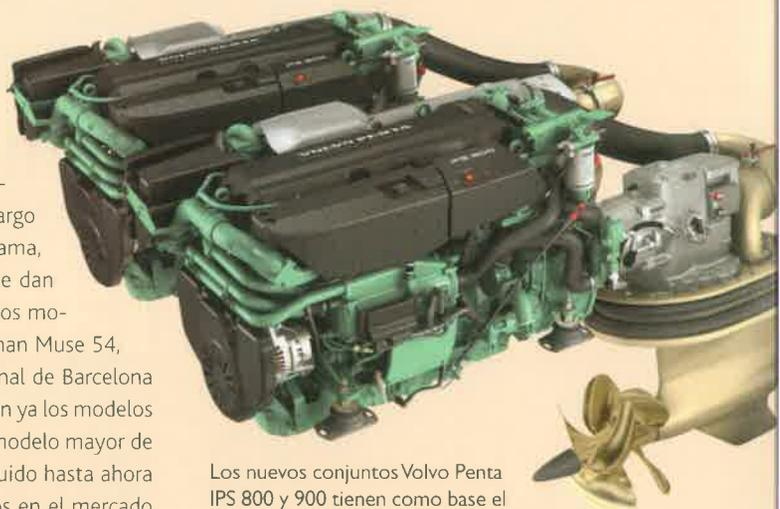
Los nuevos conjuntos Volvo Penta IPS 800 y 900 tienen como base el motor diésel D11 de seis cilindros en línea y 10,8 litros de capacidad.
