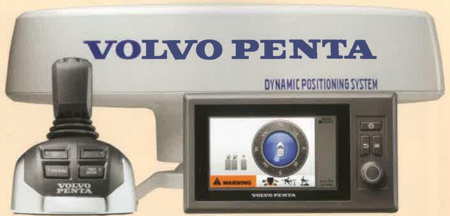
El Sistema de Posicionamiento Dinámico se controla mediante un software especial integrado en la plataforma EVC (Electronic Vesel Control) de Volvo Penta. Una antena especial con dos receptores GPS proporciona al sistema información exacta sobre la posición de la embarcación. Con esta información, el software controla las evoluciones del motor, las posiciones de cambio y las unidades propulsoras, que pueden girar de forma independiente, adelante o atrás, a babor o estribor.
