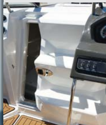
La puerta a los interiores es en fibra blanca y su forma escalonada sirve para permitir el paso entre bañera y cubierta de proa a través de la puerta central del parabrisas.
