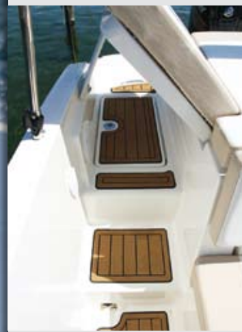
El respaldo basculante del solárium de popa puede descubrir un paso de comunicación entre plataforma y bañera, que simplificará este tránsito.
