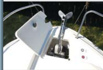
La maniobra de fondeo puede ser eléctrica y queda reducida a un contenido pero suficiente cofre de anclas. La tapa se reforzará en futuras unidades.
