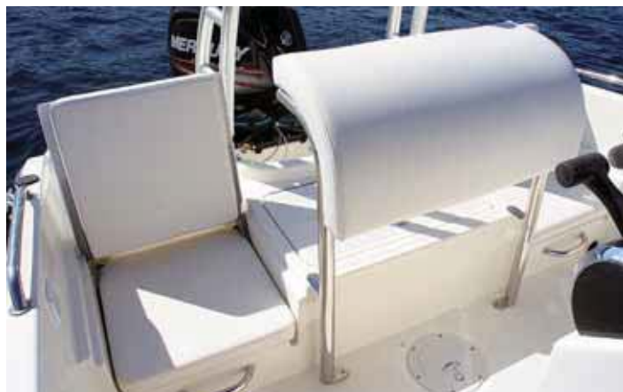
En la CC5 el asiento del piloto se desliza totalmente hacia popa.
