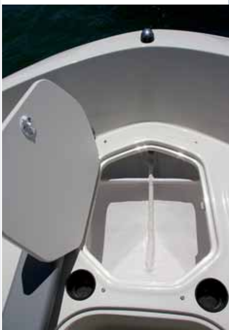
Cofre de fondeo con refuerzos.
