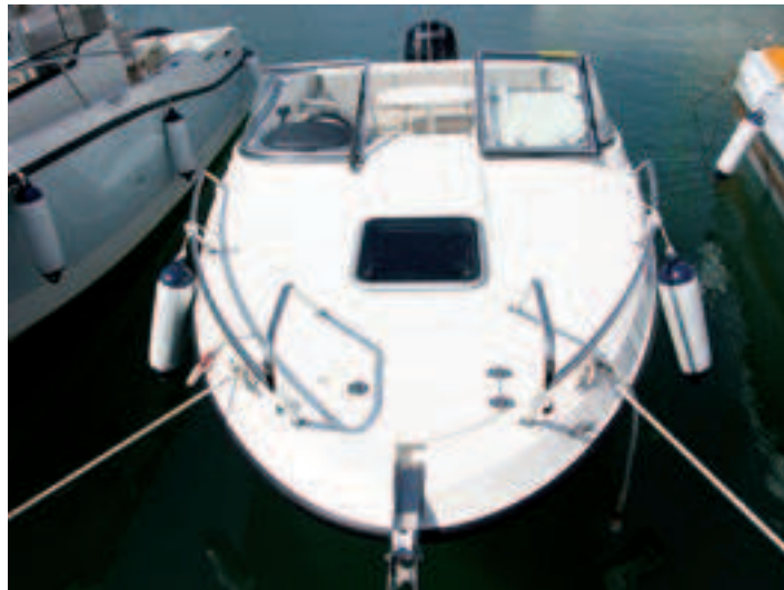
La cubierta de proa se protege mediante un elevado balcón y candeleros laterales.
