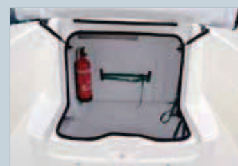
Al elevar el asiento integrado en la consola se da acceso a un generoso compartimento que permitirá fijar y estibar la mesa opcional en su interior.
