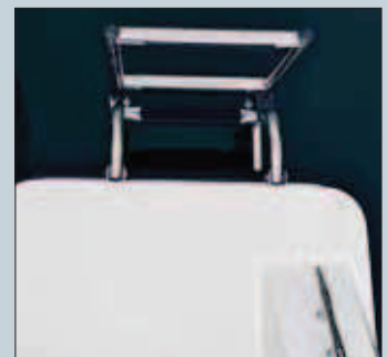
La instalación de una escalera de baño plegable en el lateral de babor facilitará el embarque desde el agua.
