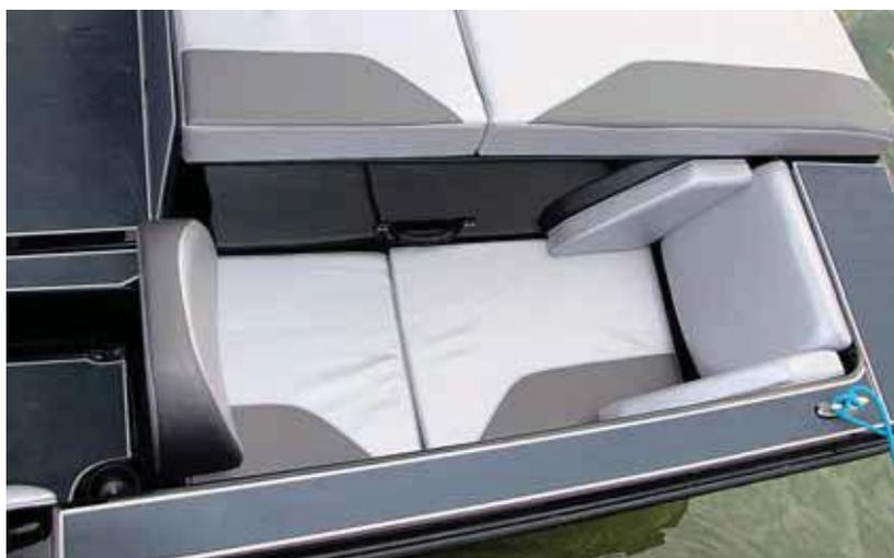
**Los respaldos desmontable permiten utilizar los asientos en dos direcciones.**
